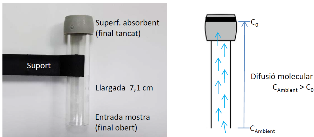
Figura 1: Principi de funcionament dels tub passius de difusió de \text{NO}_2 de tipus Palmes, on C_{\text{Ambient}} és la concentració de la mostra ambiental i C_0 és la concentració a la superfície de l'absorbent.
