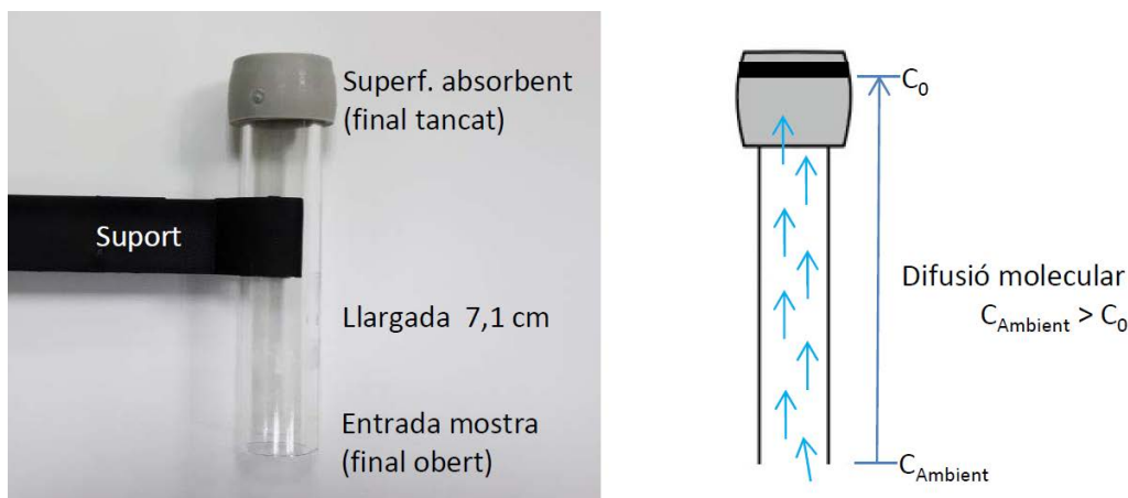
Figura 1: Principi de funcionament dels tub passius de difusió de \text{NO}_2 de tipus Palmes, on C_{\text{Ambient}} és la concentració de la mostra ambient i C_0 és la concentració a la superfície de l'absorbent.
