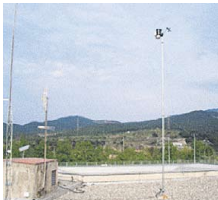
© Estació meteorològica digital de l'IES Castellar. Al centre de la imatge es pot veure el pal amb els diferents sensors. A la part inferior esquerra hi ha la webcam.
