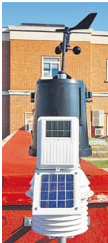
© Els sensors van equipats amb unes petites plaques solars que els permeten funcionar autònomament durant unes hores en cas que hi hagi una tallada del subministrament elèctric.
