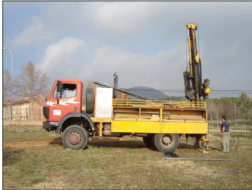
Foto 3: Màquina realitzant un dels sondejos.
