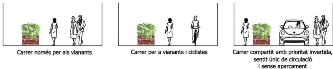
Figura 37. Possibles seccions per a carrers amb menys de 7 m d'amplada
