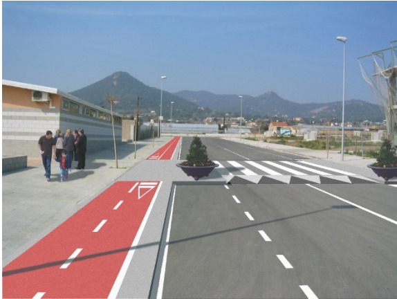
Figura 83 Fotomuntatge proposta d'atri i pas de vianants elevat, amb elements urbans (com per exemple jardineres) que ajuden a la reducció de velocitat.
