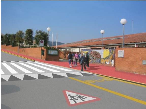
Figura 80 Fotomuntatge proposta de plataforma elevada que cobreixi tot l'entorn d'accés a l'escola i que inclogui parada de transport col·lectiu i diferents elements de mobiliari urbà.
