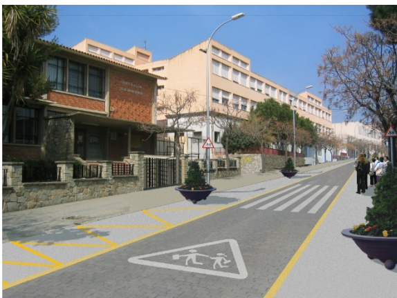
Figura 84 Fotomuntatge proposta de carrer amb paviment únic i preferència per a vianants. Velocitat límit de 20 km/h.
