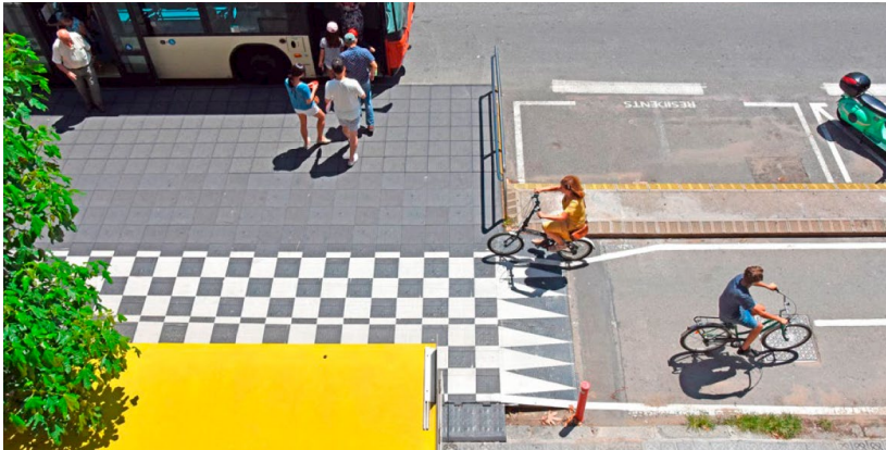
Imatge 18 Exemple de carril integrat a Barcelona. Plataforma per accedir l'autobús i integració del carril pedalable. Solució de Zicla, Sistema Vectorial.
