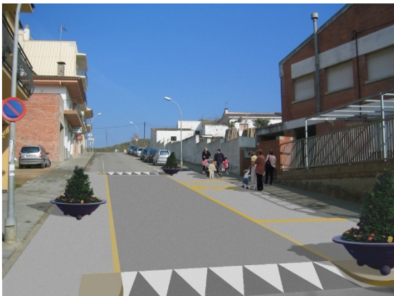
Figura 81 Fotomuntatge proposta de pas de vianants elevat i senyalització horitzontal.
