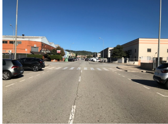
Imatge 153. Radis de gir oberts i trencament d'itinerari a peu pel pas allunyat.
