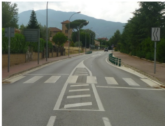
Imatge 4 Exemples de mesures de fàcil aplicació per l'estretament d'amples de calçada
